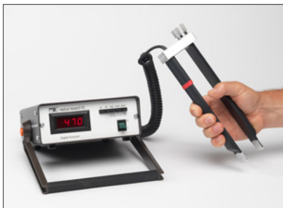
شکل ۱ - دستگاه دینامومتر دیجیتال دستی MIE digital grip analyser
