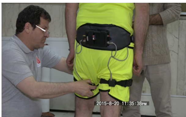
شکل شماره ۱. دستگاه شتاب سنج و نصب آن
